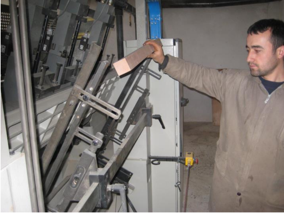
Resim 2.15: Makineye elle iş parçası bağlama
