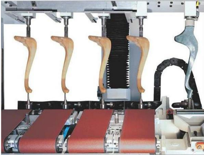
Resim 2.10: Pantograf makinesinde çalışma
