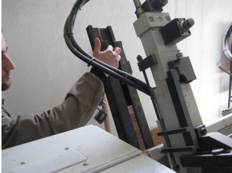
Resim 2.17 Otomatik tornaya parça yükleme
