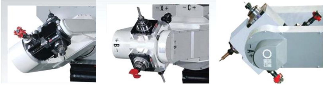
Resim 1.5: CNC Makine kesicilerinin takıldığı kovanlar
