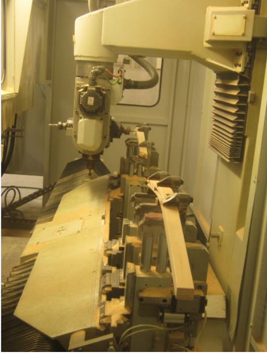
Resim 1.17: İş parçasına CNC makinesinde işlem yapılmakta
