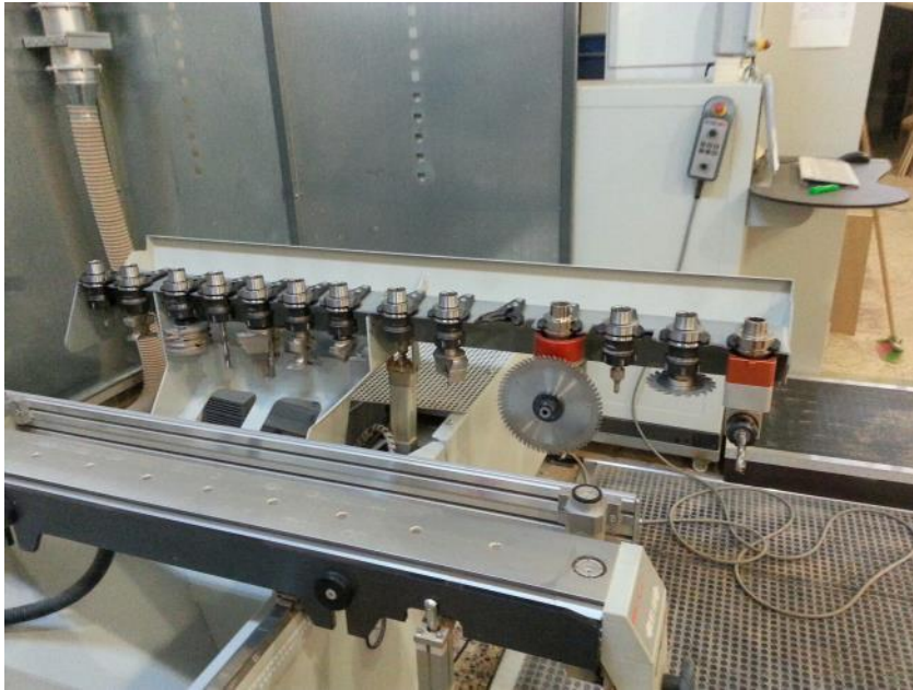
Resim 1.9: Makine üzerinde kesicilerin yerleřtirildięi kısım
