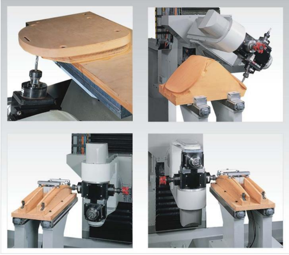
Resim 1.4: Beş eksenli CNC makinesi çalışma şekli
