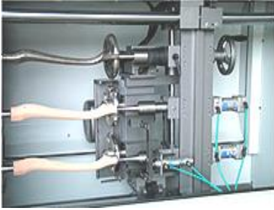
Resim 2.13: Pantograf makinesinde kopyalama üniteleri
