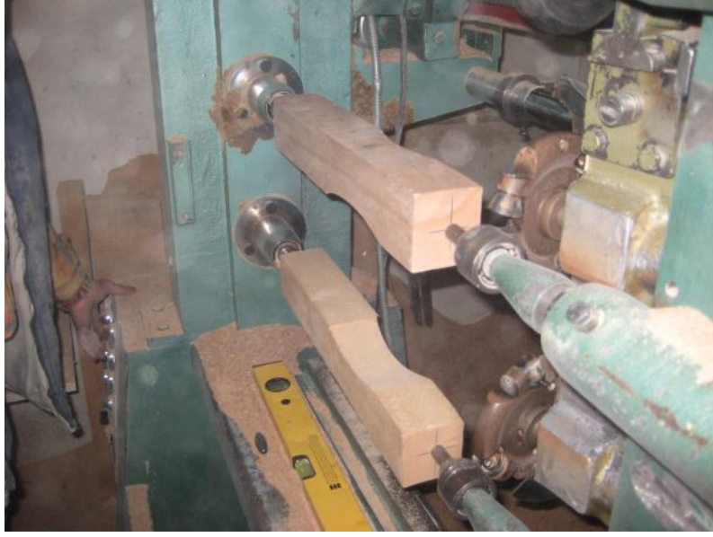
Resim 2.16: Makineye elle iş parçası bağlama
