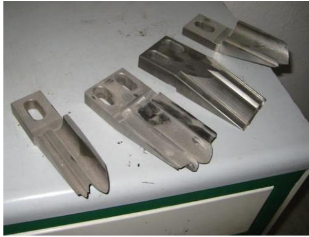
Resim 2.14: Pantograf makinesinde kullanılan kesiciler
