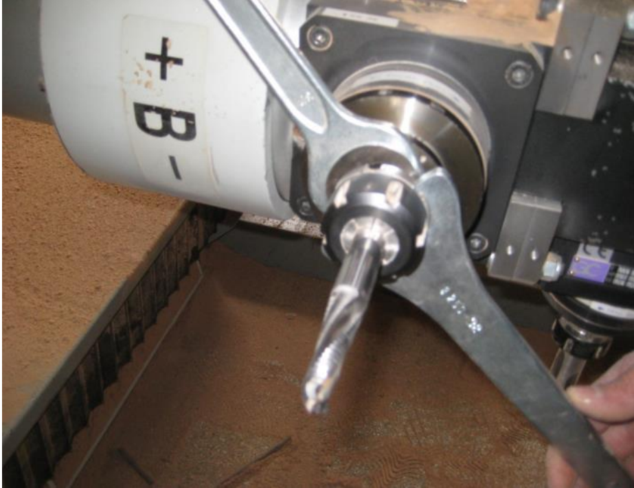
Resim 1.7: Kovan anahtarları ve kesicilerin deęiřtirilmesi
