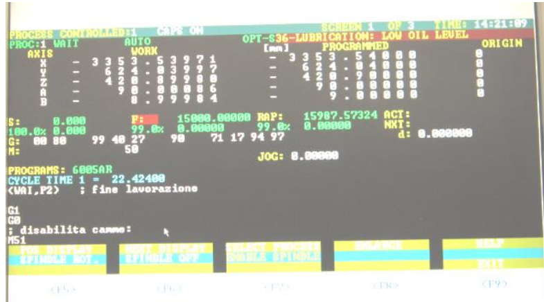
Resim 2.10: CNC makinelerinin bilgisayarlı kontrol ünitesi ekran görüntüsü
