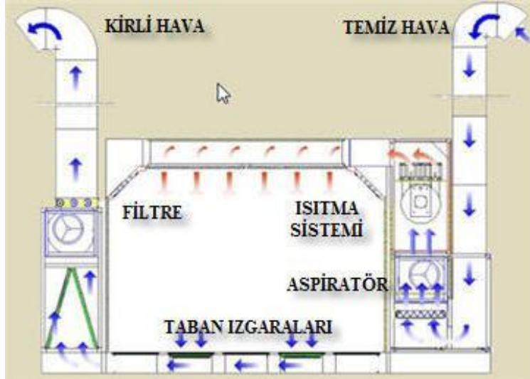
Şekil 2.3: Vernik kabini şeması
