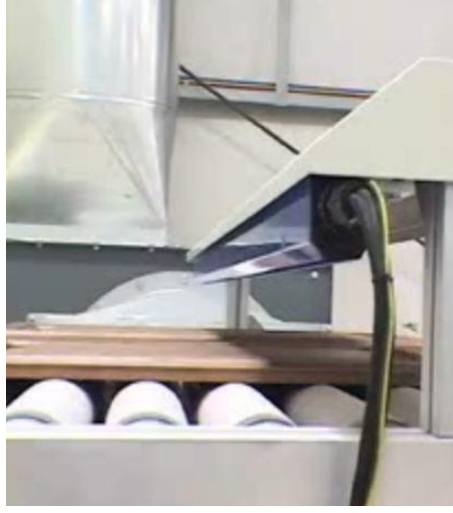
Resim 3.10: Ultraviyole kurutma eklenmiş seri üretim bandı
