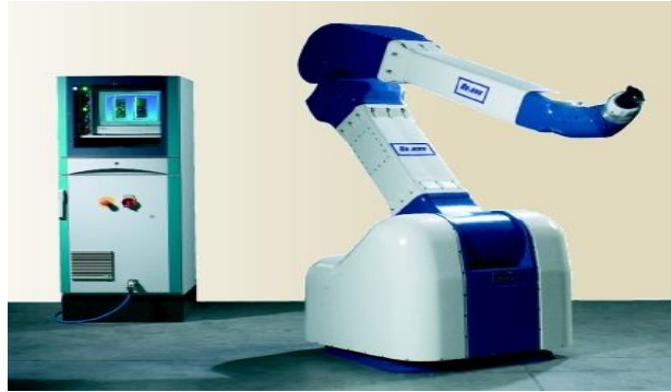
Resim 2.3: Robot kol ve programlama ünitesi
