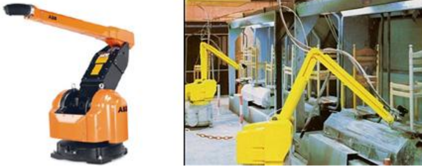
Resim 2.5: Çok eksenli robot ile vernikleme kabini
