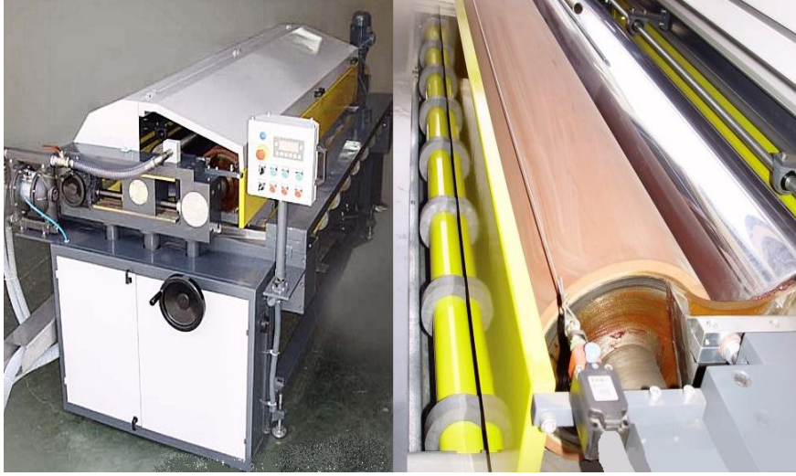
Resim 1.2: Silindirli vernikleme makinesi ve silindirler
