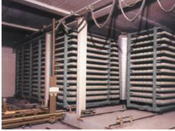
Resim 3.1: Katlı kurutma raflarının kurutma fırınına yerleştirilmesi
