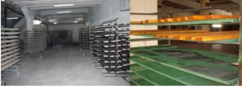
Resim 3.2: Katlı kurutma raflarına verniklenen iş parçalarının dizilmesi
