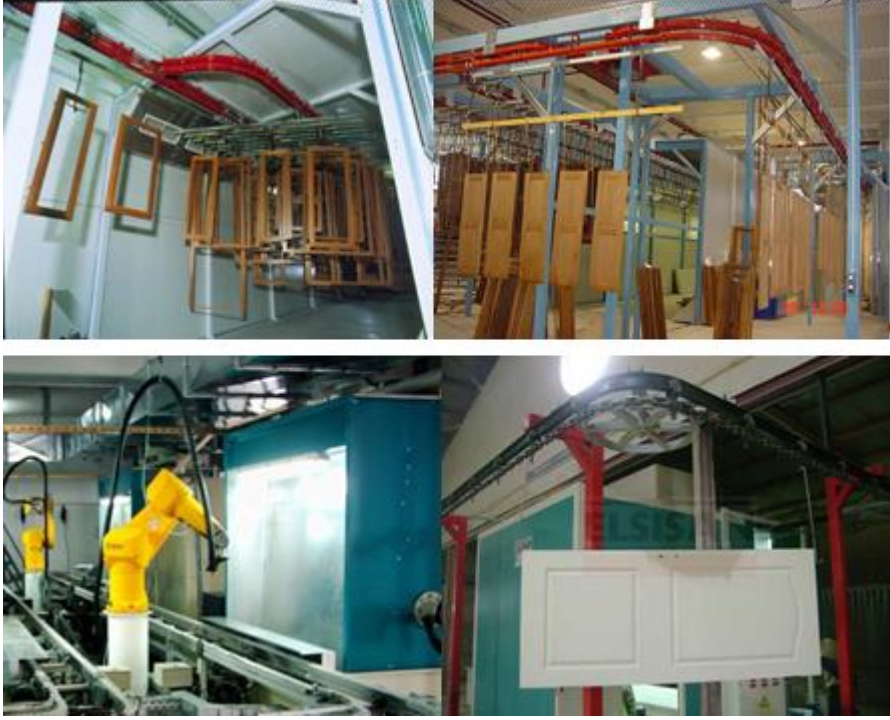
Resim 2.17: Kabine iş parçasının giriş çıkışını sağlayan konveyörler
