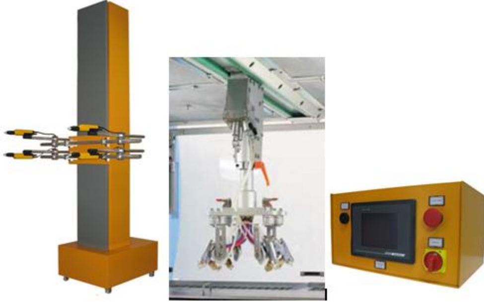
Resim 2.4: Yatay ve düşey tek eksenli robotlar ve kumanda paneli
