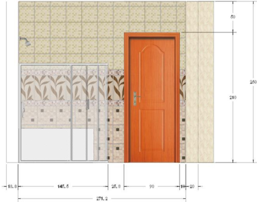
Çizim 1.24: B-B' cephe görünüşü desen ve renklendirilmesi
