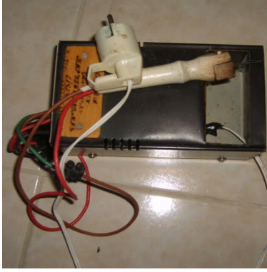
Resim 2.3: Örnek yakma makinesi ve ucu
