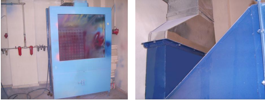
Resim 1.10: Boyama kabini ve havalandırma sistemi
