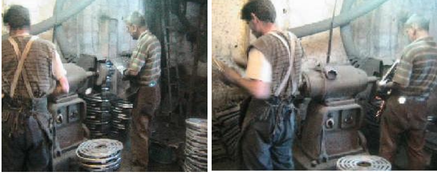
Resim 3.4: Parlatma işlemi ve havalandırma tesisatı
