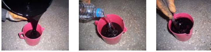
Resim 3.8: Boyanın hazırlanması (tinerle inceltilmesi) aşamaları
