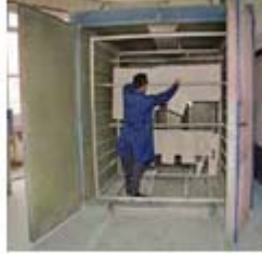
Resim 5.15: Parçaların fırına sürülmesi ve pişirilmesi
