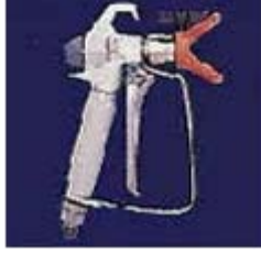
Resim 4.6: Boya püskürtme ayarı kırmızı renkli ucun döndürülmesi ile yapılır.
