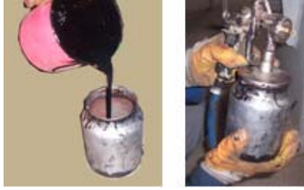
Resim 4.5: Boyanın hazırlanarak tabanca haznesine konulması
