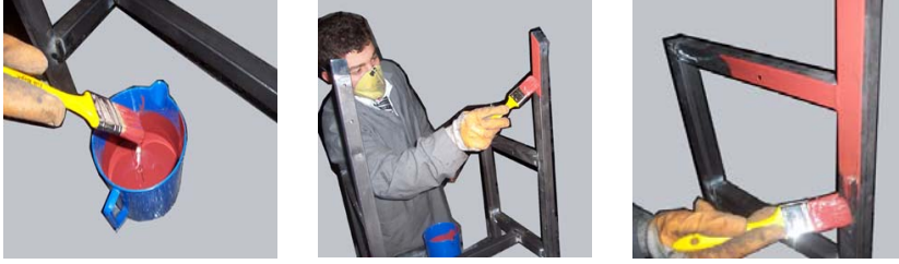
Resim 1.8: Astar boyayı akıntısız olarak fırça ile uygulama
