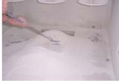
Resim 5.10: Kompresör hava basıncının ayarlanması, toz boyanın, boya deposuna konulması
