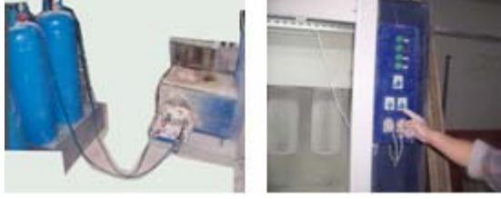
Resim 5.12: Boya fırının ve kabininin çalıştırılması (fırın elektrik veya yakıt özelliğine göre çalıştırılarak istenilen dereceye getirilir.)
