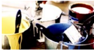
Resim 3.7: Boyadan sonra fırçaların temizlenmeden bırakılması (böyle bir hatalı uygulama, fırçaların donmasına ve tekrar kullanılamamasına neden olur)
