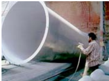
Resim 4.7: Tabanca ile boyayı akıntısız olarak yüzeye uygulama
