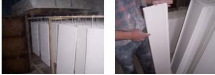
Resim 5.16: Parçaların fırından çıkarılarak kendi halinde soğutulmaları, soğuduktan sonra boyanın son kontrolünün yapılması
