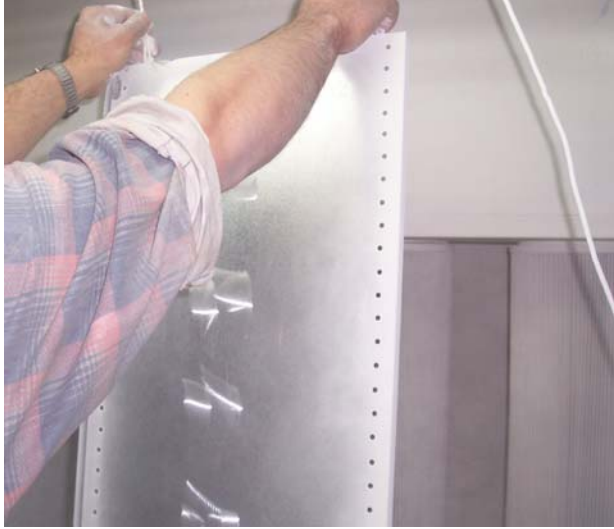
Resim 5.13: Boyanacak parçaların kabine asılması
