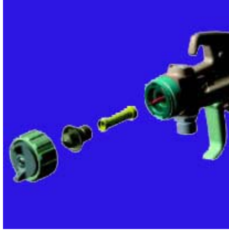
Resim 4.4: Tabancanın sklebilir kısımları (Sklebilir kısımlar boyadan sonra sklrek temizlenmelidir.)
