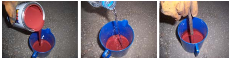
Resim 1.7: Astar boyayı uygun inceltici ile hazırlama aşamaları
