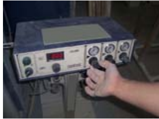
Resim 5.11: Tabancanın püskürtme, hava ve voltaj ayarlarının yapılması
