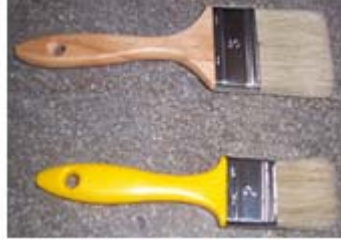
Resim 3.6: Boya uygulamasında kullanılan ahşap ve plastik saplı fırçalar
