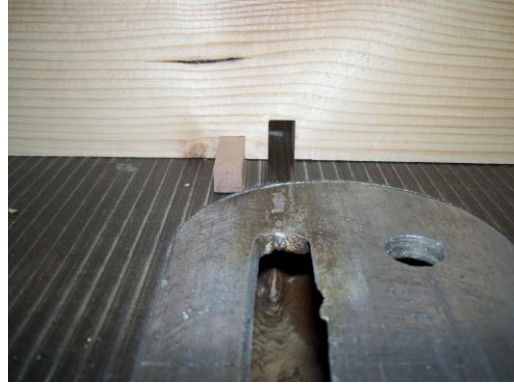
Resim 2.14: Düz diş kalıbı ve kılavuz parçası
