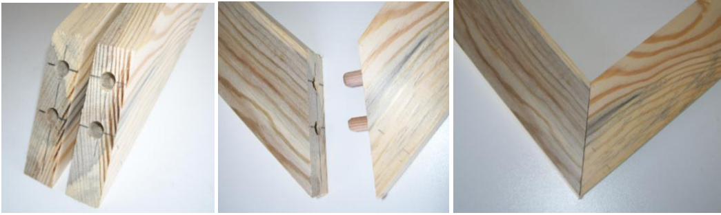
Resim 2.4: Gönyeburun kavelalı çerçeve köşe birleştirme
