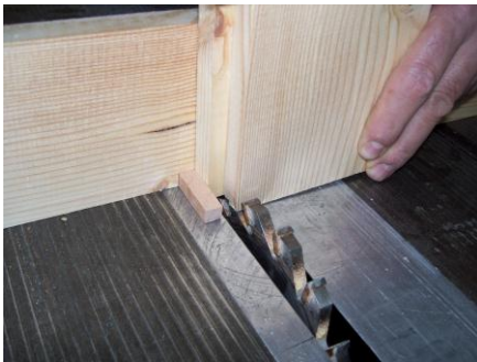
Resim 2.15: Düz diş kalıbına parça yerleştirme
