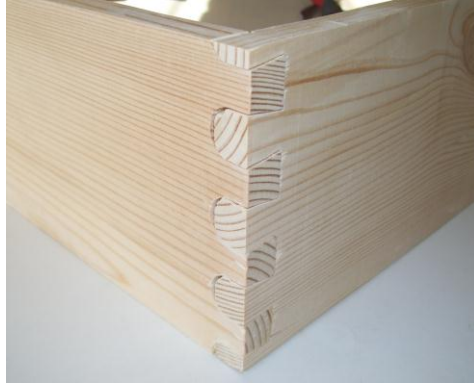
Resim 2.24: Kırlangıç kuyruğu yarım gizli dişli birleştirme
