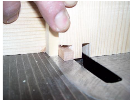
Resim 2.16: Düz diş kalıbı ile ikinci dişin açılması
