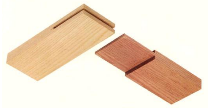
Resim 2.1: Açık zıvanalı çerçeve köşe birleştirme
