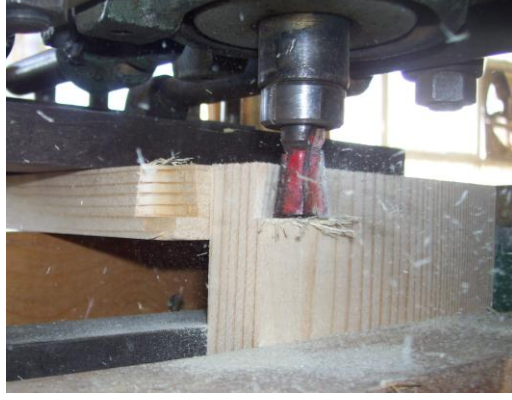
Resim 2.20: Kırlandıçkuyruęu diř ama makinesinde ilk diřin aılması
