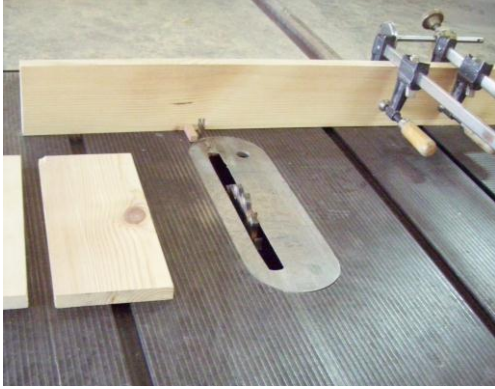
Resim 2.13: Düz diş kalıbı ve kılavuz parçası
