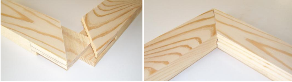
Resim 2.7: Açık zıvanalı 1/3 lambalı, pahlı bir yüzü gönyeburun çerçeve köşe birleştirme
