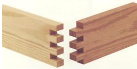
Resim 2.12: Düz dişli köşe birleştirme
