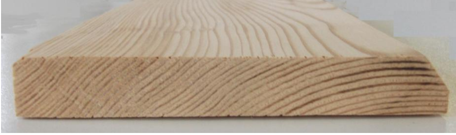
Resim 1.4: Pah kırılmış iş parçası resmi
