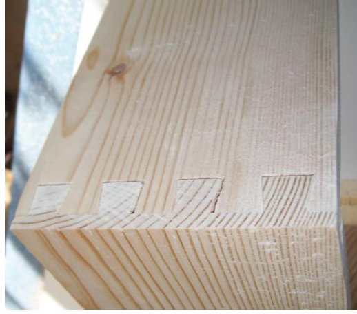
Resim Hata! Belgede belirtilen stilde metne rastlanmadı..25: Kırlangıçkuyruğu yarım gizli dişli köşe birleştirme
