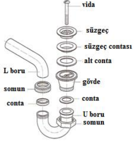
Şekil 5.15: Sifonun sıralı görüntüsü
