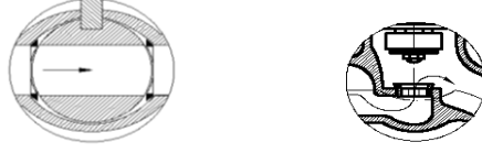
řekil 1.3: Kresel ve contalı musluđun i yapısı
