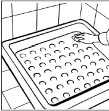
Şekil 5.13: Sifonun ağzının kapatılması işlemi
