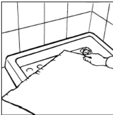
Şekil 5.14: İnşaat bitene kadar korumaya alma işlemi
